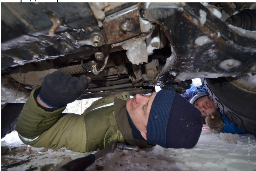
Mitsubishi L200 стал заднеприводным, оторвался шланг пневмосистемы, подключающей передний привод
